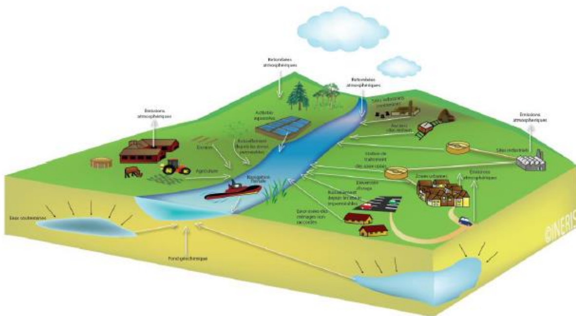
Figure 69 : Schéma conceptuel des différentes voies d'apports de micropolluants aux eaux de surface considérées dans le cadre de la réalisation d'un inventaire des émissions (Source : INERIS)
